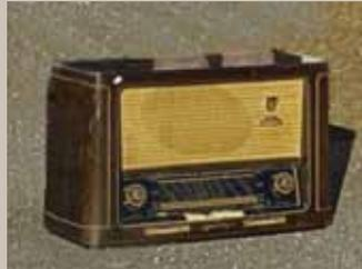
Autrefois on pouvait écouter la radio grâce au **POSTE À LAMPE**. Appareil encombrant, il fallait attendre qu'il chauffe pour fonctionner. Il a peu à peu été remplacé par le transistor, portable et à ondes modulables.
