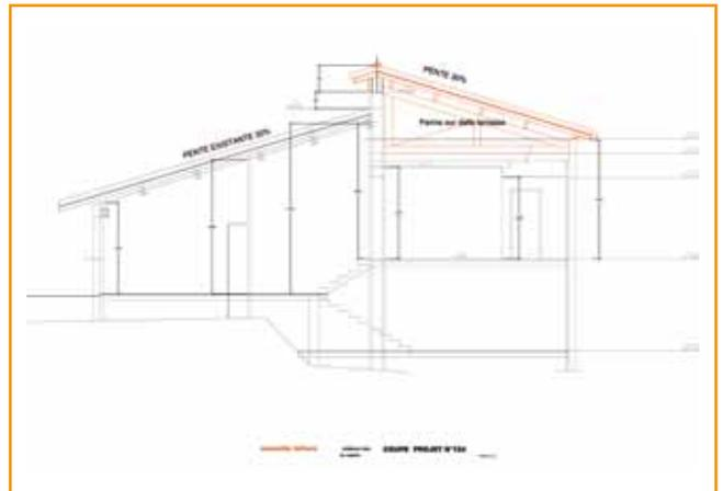
Pour les parties extérieures, nous coifferons le toit terrasse d'une couverture en tuiles côté Est et reprendre l'étanchéité de la toiture existante côté Ouest. Les façades Est et Sud vont être habillées en pierres dorées et un enduit est prévu sur les façades Ouest et Nord.
